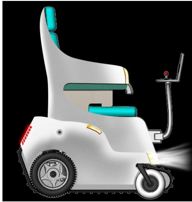
图 41: 迈康信医用实时监测康复型机器人可解决“爬楼”问题
