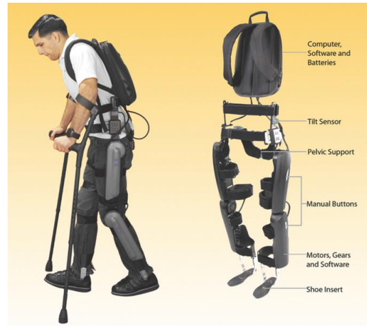
图 16: ReWalk 模仿自然行走的步态
