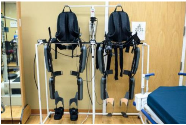
图 15: ReWalk 通过电池驱动关节部位电机
